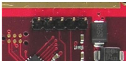
5 polige Steckbrücke (Rastermass 2,54mm). Die Pins von links nach rechts:
