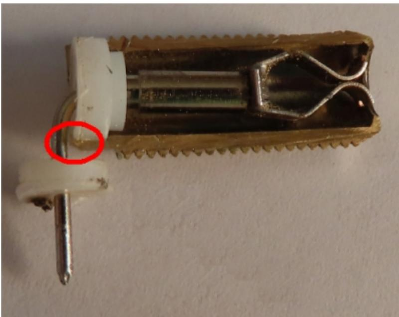
Erhitzt man die Buchse zu stark, kann es gegebenenfalls durch das deformierte Dielektrikum auch an zwei weiteren Stellen zu Kurzschlüssen kommen
