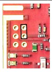
Nach dem Anschluss der 12-V-Versorgungsleitung und evtl. Stecken von Jumpern zur Frequenzwahl kann der Deckel des Weißblechgehäuses aufgesteckt werden. Zum Abschluss klebt man eine Beschriftung auf. Der Deckel wird nicht verlötet, da man evtl. noch Einstellungen auf der Platine vornehmen muss (z.B. Jumper).
