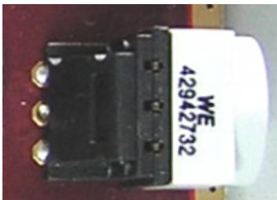
Ein Schalter mit 10 Stellungen erlaubt die Auswahl der Ausgangsfrequenz. Die Anzeige bezieht sich auf die alte Frequenz der CW Bake. Diese war ursprünglich auf 10489,550 MHz und wurde im Rahmen der Erweiterung des Schmalbandtransponders (von 250 kHz auf 500 kHz) um 50 kHz nach unten auf 10489,500 Mhz verschoben.
