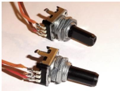
Drehgeber haben zwei interne Schalter mit einem gemeinsamen Pin (normalerweise der mittlere), welcher auf GND verdrahtet wird. Die beiden äußeren Pins geben beim Drehen ein phasenverschobenes Rechtecksignal aus welches an GPIO Pins der Raspberry Steckerleiste angelegt wird.
