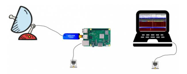
der Ausgang des QO-100 LNBs hängt am Eingang eines RTL-SDR Sticks (oder Pluto bzw SDRplay).
