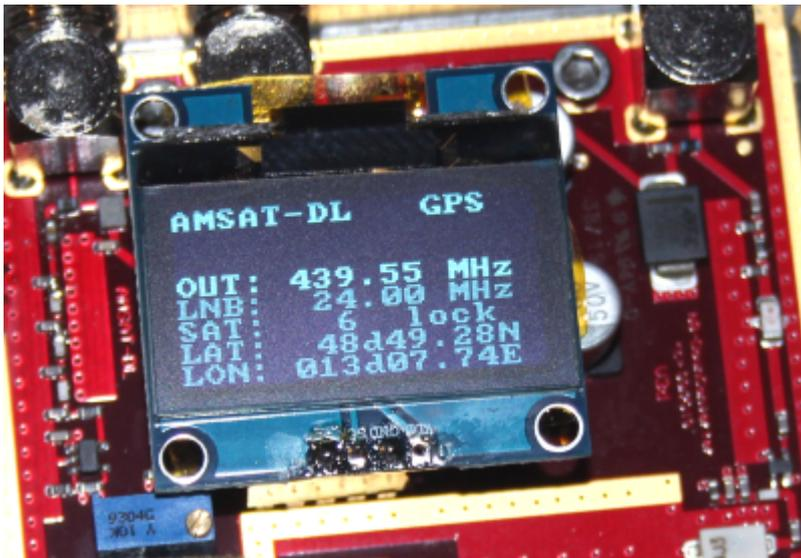
Nach dem Programmstart werden Statusinformationen angezeigt welche den LEDs A bis D entsprechen. Sobald das System synchronisiert ist zeigt das Display Frequenzinformationen, bei montiertem GPS Modul auch GPS Daten.
