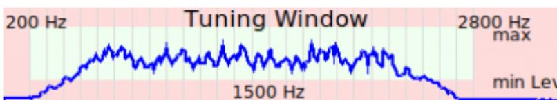
Zwischen Sendefrequenz und Empfangsfrequenz kann es manchmal einen kleinen Offset geben. Selbst bei GPS stabilisierten Systemen können systembedingt bis zu  $\pm 50$  Hz Abweichung auftreten. Mit der RIT-Funktion des Transceivers korrigiert man gegebenenfalls Abweichungen um das Spektrum in die Mitte des grünen Bereichs zu stellen. Bild 11b zeigt eine falsche Einstellung, die Frequenz ist hier zu niedrig eingestellt.
