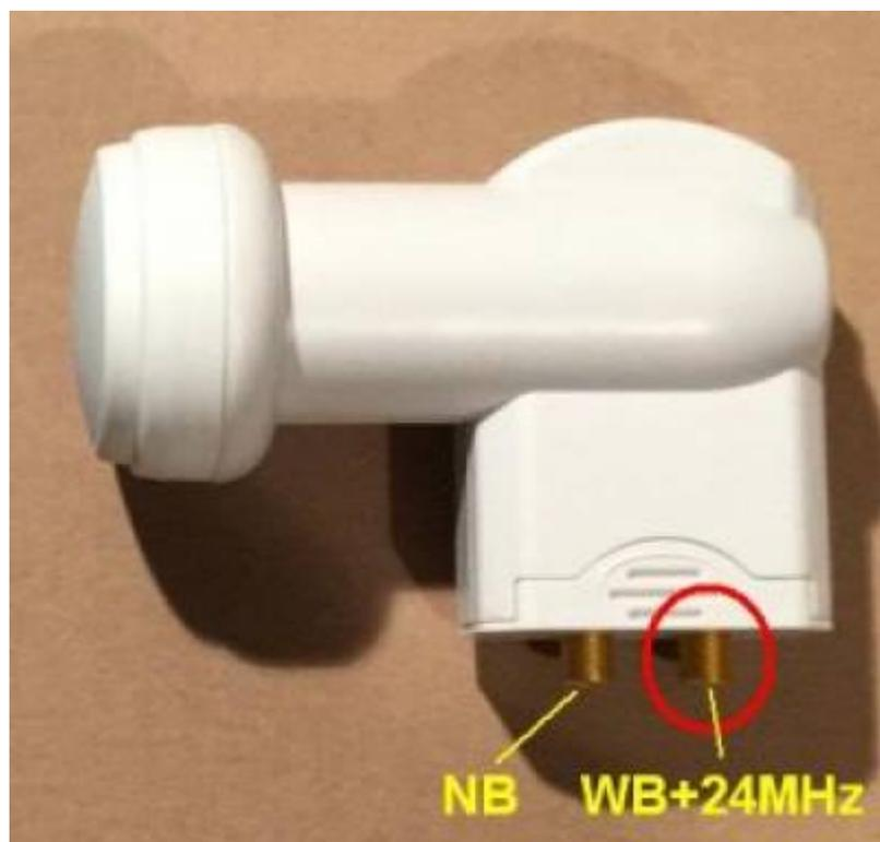
Die Referenzclock wird direkt aus dem DownConverter V3d gespeist und dort durch einen hochstabilen TCXO+GPS (GPDSDO) erzeugt. Ein zusätzliches externes GPDSDO ist nicht erforderlich.
