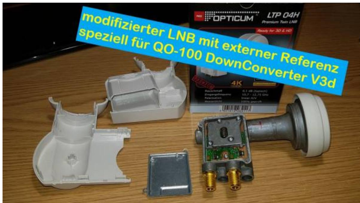
Es handelt sich hierbei um einen umgebauten OPTICUM LTP 04H LNB, ideal für Betrieb mit dem AMSAT-DL QO-100 DownConverter V3d.
