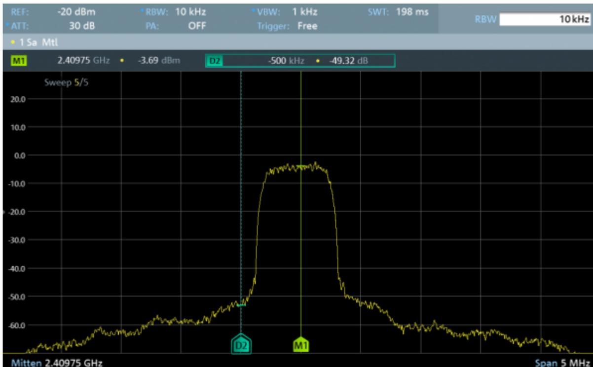
Bei einer weiteren Erhöhung des Ausgangspegels auf 35.3dBm entsprechend 3.3W ist der Schulterabstand nur noch ca. 37dB. Weiter sollte die Ausgangsleistung nicht erhöht werden. Da in der Regel eine weitere Endstufe nachgeschaltet wird soll man die hier beschriebenen 6W PA für DATV mit QPSK Modulation eher bei maximal 2W Ausgangsleistung betreiben.
