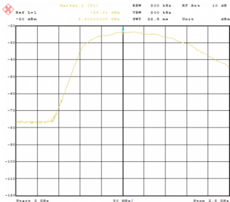
Die beiden kaskadierten Bandpassfilter dämpfen Signale unterhalb von 2120MHz um mehr als 55dB. Tatsächlich ist die Unterdrückung noch höher allerdings war die Messung durch den Dynmikbereich des Messaufbaus begrenzt. Vewendet man einen Upconverter mit einer Zwischenfrequenz von 435MHz, so liegt der Lokaloszillator in der Regel bei 1965MHz und die Spiegelfrequenz bei 1530MHz. Falls der Upconverter diese Signale nicht gut unterdrückt so werden sie spätestens in dieser PA ausreichend abgesenkt.
