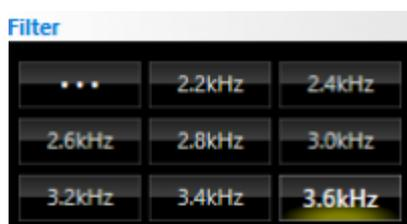
Man benutzt das unterste Filter (3,6kHz). **Hier ist es wichtig die untere Grenzfrequenz auf 0 Hz zu stellen**, da HSmodem den kompletten Bereich nutzt.
